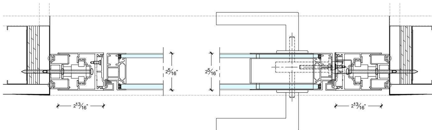
STANDARD DOUBLE GLAZED PIVOT DOOR ON A WALL-TO-WALL CONDITION
