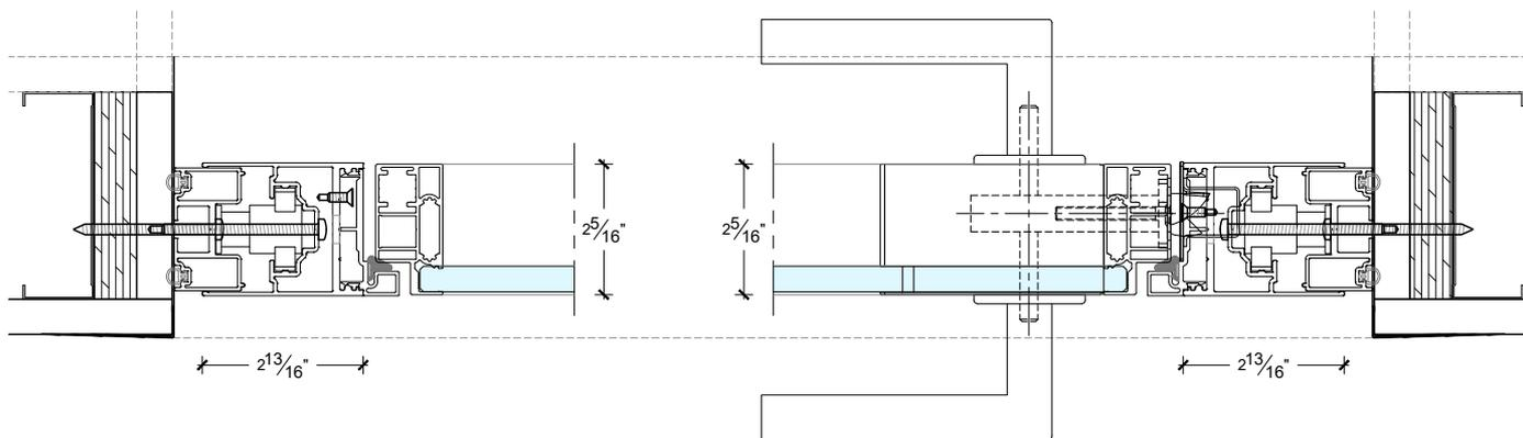
STANDARD SINGLE GLAZED PIVOT DOOR ON A WALL-TO-WALL CONDITION
