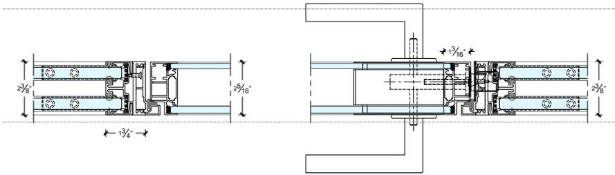
STANDARD DOUBLE GLAZED PIVOT DOOR WITH LEVER ON A FIXED DOUBLE GLAZED WALL
