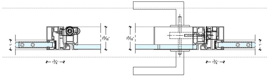
STANDARD SINGLE GLAZED PIVOT DOOR WITH LEVER ON A FIXED SINGLE GLAZED WALL
